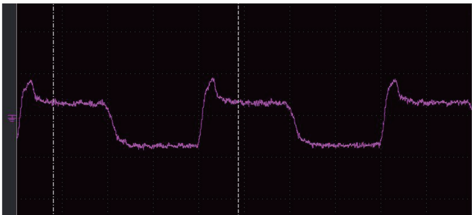
图 6 实测模拟 CCD 信号图
