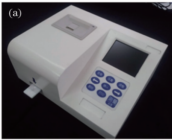
图 2 (a) 金标试纸条阅读仪实物图；(b) 金标试纸条阅读仪结构图
