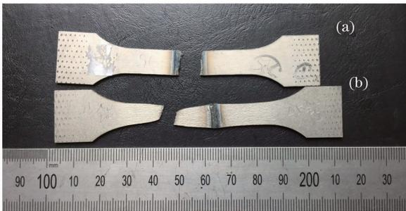
图 9 拉伸断裂图。(a) TC4 钛合金焊缝；
