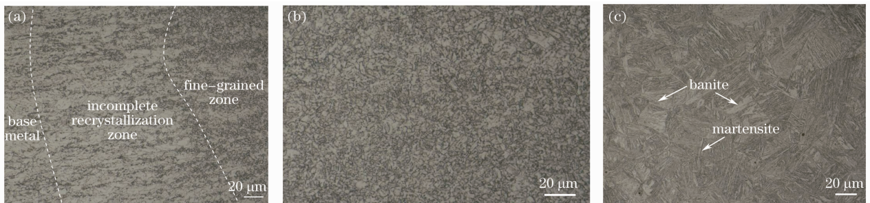
图 10 热影响区组织形貌(A区)。(a)不完全重结晶区;(b)细晶区;(c)过热区
