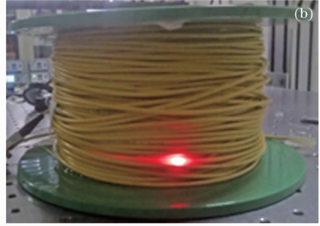
图 3 单反射事件测量结果。(a)红光混沌互相关法对光纤故障距离信息的测量结果;(b)光纤故障位置因红光混沌泄漏而产生的亮斑
