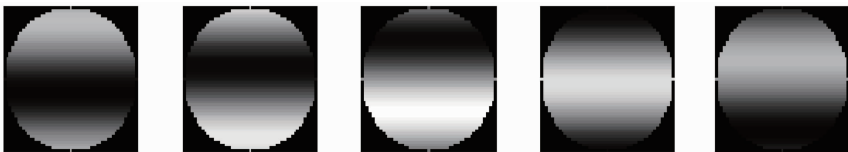
图 5 计算机生成五步移相正弦条纹图
