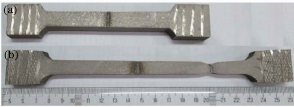
图 10 拉伸试件及断裂图。(a) 未拉伸试件; (b) 拉伸后断裂试件
