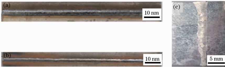
图5 2号试样的焊缝形状。(a)正面;(b)背面;(c)横断面
