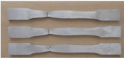
图 9 2 号试样的拉伸试件形貌
