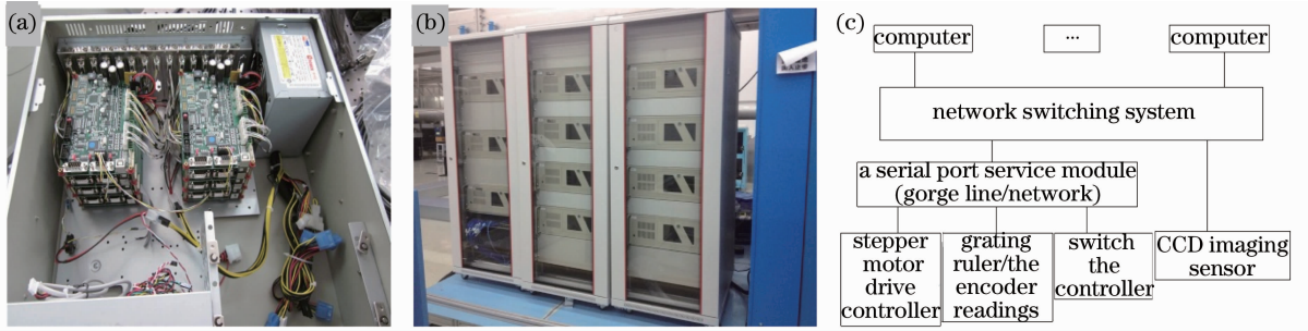
图 7 集控系统示意图。(a) 控制箱示意图; (b) 控制柜; (c) 控制系统结构图
