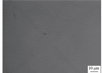
图 5 304 不锈钢未冲击区的表面微观形貌
