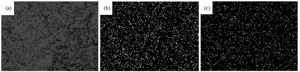
图 5 合金涂层背散射电子像和元素的面分布。(a)背散射图;(b) Nb 元素;(c) Si 元素
