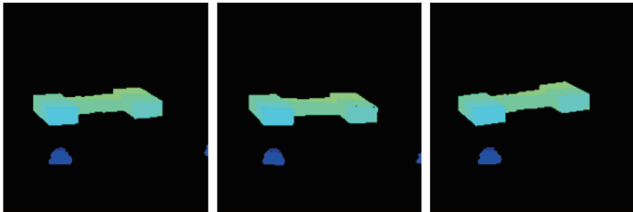
图 7 成像帧频为 20 Hz 时的目标合成距离像
