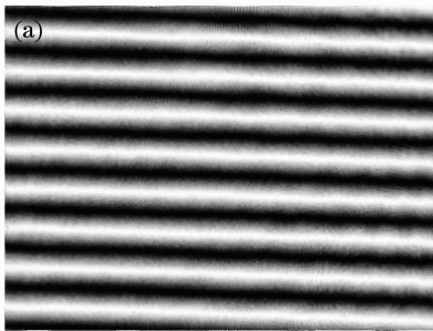
图 4 双 CCD 镜像重叠位置调节实验效果图。(a)记录距离一致时两球面波的干涉图; (b)基本镜像重叠时两球面波的干涉图
