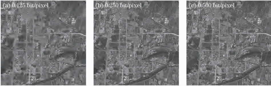
图 4 不同解码率下 ESP-DCT 算法针对遥感图像的解码结果
