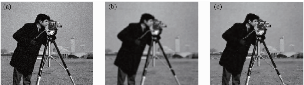
图 1 (a)噪声图像;(b)利用高斯滤波器消除噪声;(c)图像在经过掩膜处理后利用高斯滤波器消除噪声
