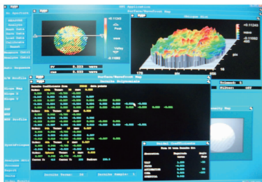
图 5 定焦实验中一幅 Zygo 干涉仪界面图
