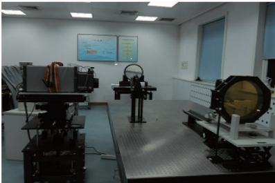
图 4 干涉法定焦实物图
