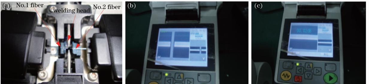
图 2 光纤熔接机。(a)内部结构;(b)焊接前外部显示;(c)焊接后外部显示
