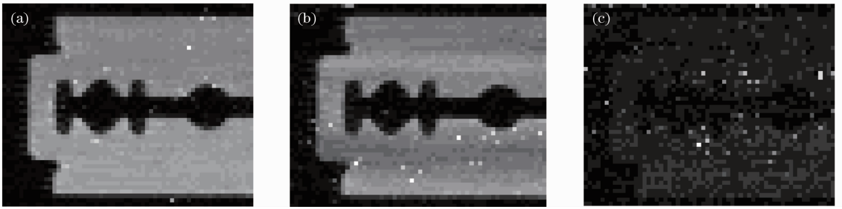
图2 刀片透过目标前不同遮挡物的成像结果。(a) 4张纸;(b)信封;(c)实验服
