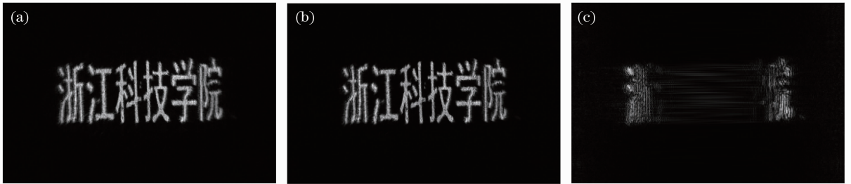
图 6 (a)由倾斜面到平行平面的反向插值重建图;(b)由全息图直接在相同平行平面上的重建图; (c)两幅图相减的绝对误差图
