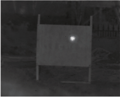
图 11 红外相机采集的激光光斑图像
