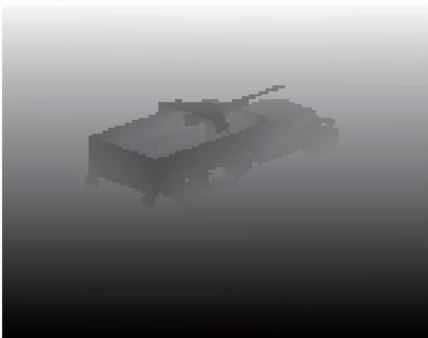
图 4 装甲车 C 的激光成像雷达距离像
