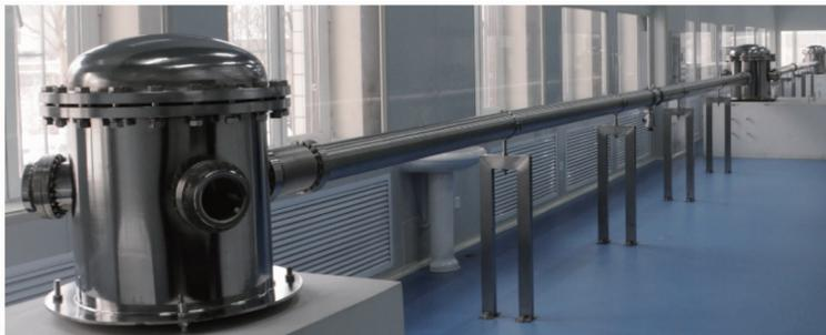
图 5 长基线激光干涉仪光路密封装置
