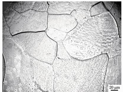
图 4 激光立体成形 Ti-2Al-16V 的显微组织
