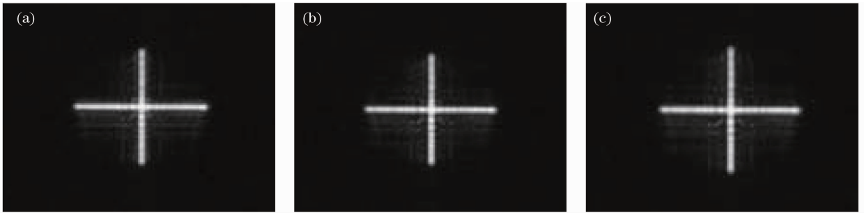
图2 微缩成像随 z 轴距离变化的微缩成像。(a)焦点前 8\ \mu\text{m} ；(b)焦点处；(c)焦点后 8\ \mu\text{m}
