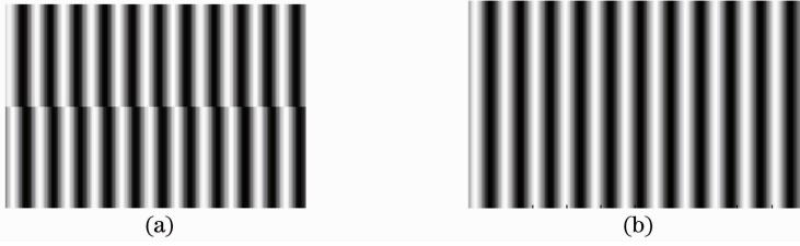
图4 对准过程中的叠栅条纹分布。(a)未对准;(b)完全对准
