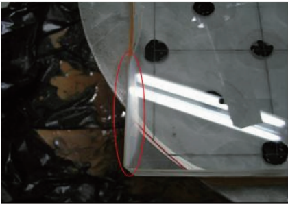
图 4 方形光学元件加工中产生的四角塌边误差 Fig. 4 Propeller error generate in grinding operation
