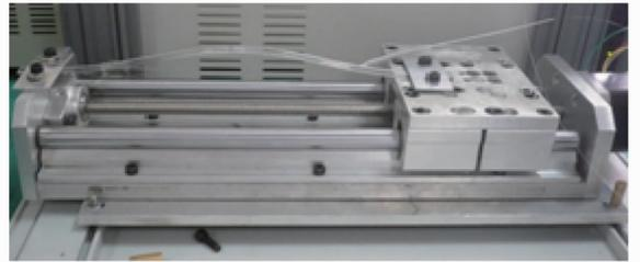
图 8 FBG 压杆调谐装置。(a)调谐实验示意图;(b)调谐装置实物图
