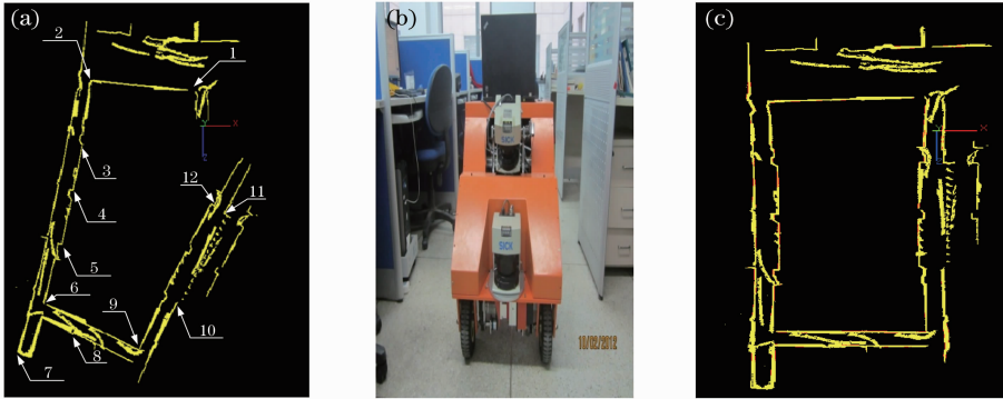
图 5 (a) 环形走廊的原始点云数据;(b) 车载移动测绘系统;(c) 环形走廊校正后的点云数据
