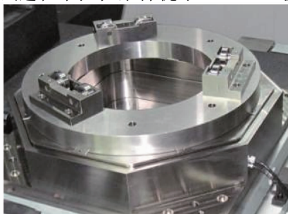
图 5 高复现性检测支撑装置
