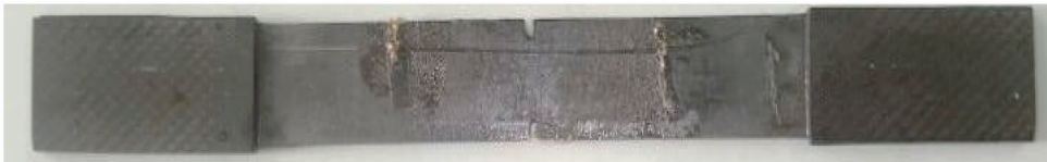
图 2 复合材料外贴啁啾光栅
