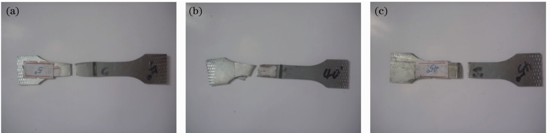
图 8 不同入射角的拉伸断裂图。(a) 5°;(b) 40°;(c) 45°
