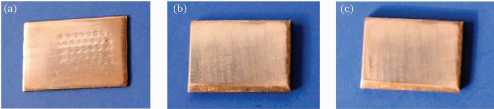
图 8 激光喷丸试样。(a) 相切; (b) 30% 搭接率; (c) 50% 搭接率
