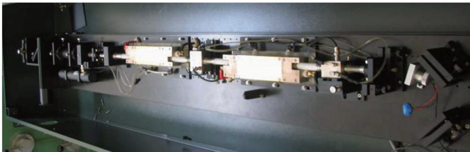
图 1 双声光调制激光器
