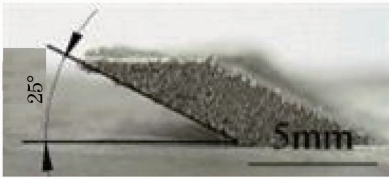
图 8 扫描速度 600 mm/s 时的极限成型角 Fig. 8 Critical fabrication angle under 600 mm/s scanning speed
