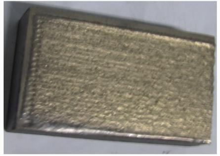
图 1 复合涂层熔覆层形貌
