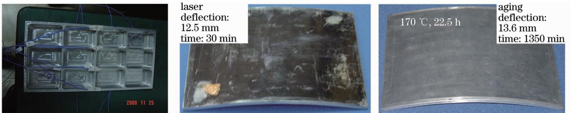
图 26 7075 铝合金结构样件在不同方法下的成形效果
