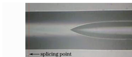
图 2 SMF 与内壁波导型毛细管光纤熔接处
