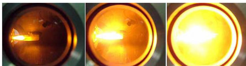
图 6 功率密度  $q=127.0 \text{ W}/\text{cm}^2$  时 CA02-A 试样典型点火过程
