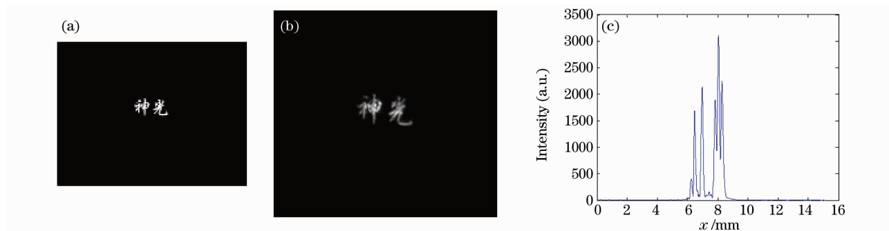
图 5 (a) 设置 DMD 的透光分布,(b) CCD 接收面光斑,(c) 第 1024 行的一维强度分布
