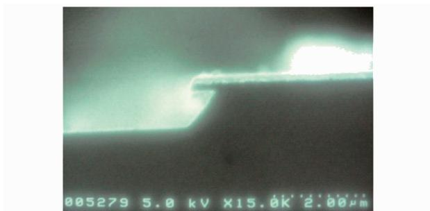
图 3 808 nm AlGaAs/GaAs 外延片腐蚀后截面扫描电镜图
