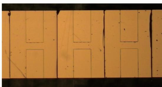
图 4 解理后的对称管芯 p 面形貌
