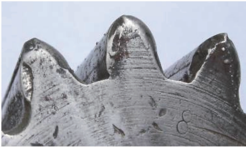
图 8 实际熔覆中的齿顶塌陷现象
