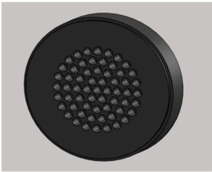
图 1 射流式水冷镜基体示意图
