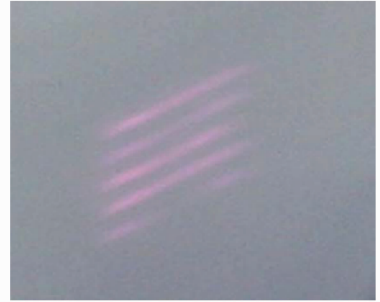
图 5 整形前 LD 阵列的光斑分布 Fig. 5 Light spot of LD before shaping
