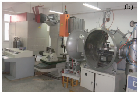
图 1 钛合金激光金属直接成形系统。(a)系统结构框图;(b)设备实物图
