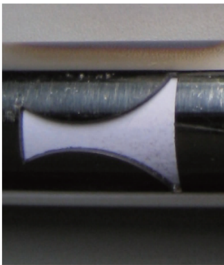
图 6 采用最佳工艺参数切割的过流曲线
