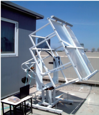
图 1 太阳光抽运激光器系统
