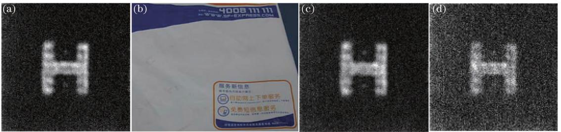
图 3 透过遮挡物的成像结果。(a)原始图像,(b)快递信封实物照,(c)透过信封成像结果,(d)透过 A4 纸成像结果
