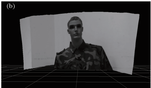
图 7 激光雷达重建效果图。(a)三维模型,(b)纹理映射后的重建效果 Fig. 7 Ladar reconstruction map. (a) three-dimensional model, (b) texture mapping
