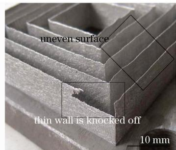
图 8 采用普通铺粉装置成型的方框
