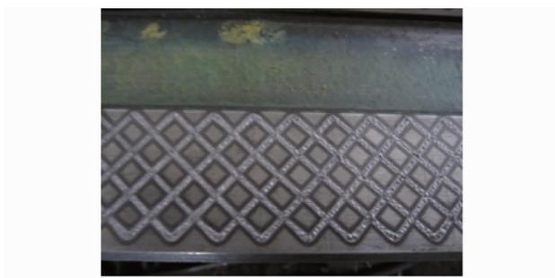
图 9 基于矩形平面测量加工的效果图
